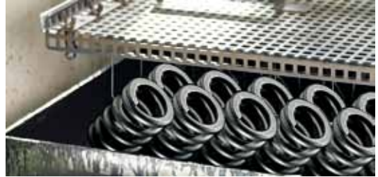
Beschichtung von Federn mittels Tauchanlage
