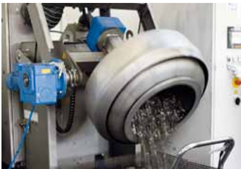
Sprühtrommel, eine optimale Komplettlösung zur Oberflächenbeschichtung von Massenkleinteilen
