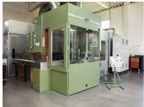
Kettenautomat mit einer Gesamtkettenlänge von 53 m
