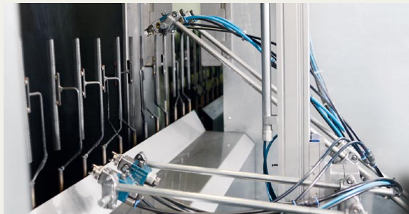
Einsatzbeispiel für den neue Kettenautomat: Partielle Gewindebeschichtungen in definierten Schichtstärken
