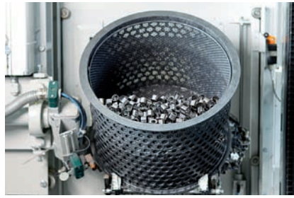
Kleinteile können per Sprühtrommel beschichtet oder in einer Tauchzentrifuge mit Lack geflutet und abgeschleudert werden.
