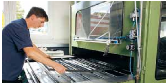
Flächenspritzautomat zur homogenen Lackierung flacher Bauteile
