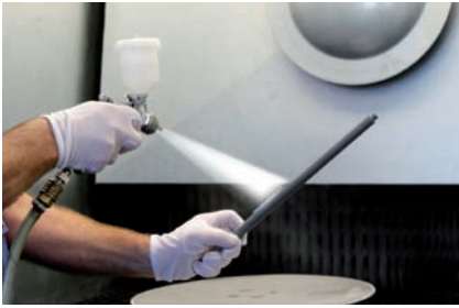
Die Applikation von Gleitlacken kann bei Spezialteilen oder Kleinserien auch manuell in der Spritzkabine erfolgen.
