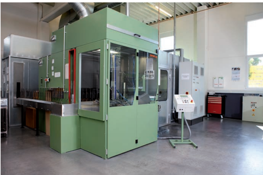
Mit einer Gesamtkettenlänge von 53 Metern und 1.040 Aufnahmen ist der Kettenautomat in der
